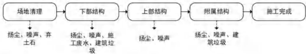
图 2-55 桥梁施工工艺及产污环节图
