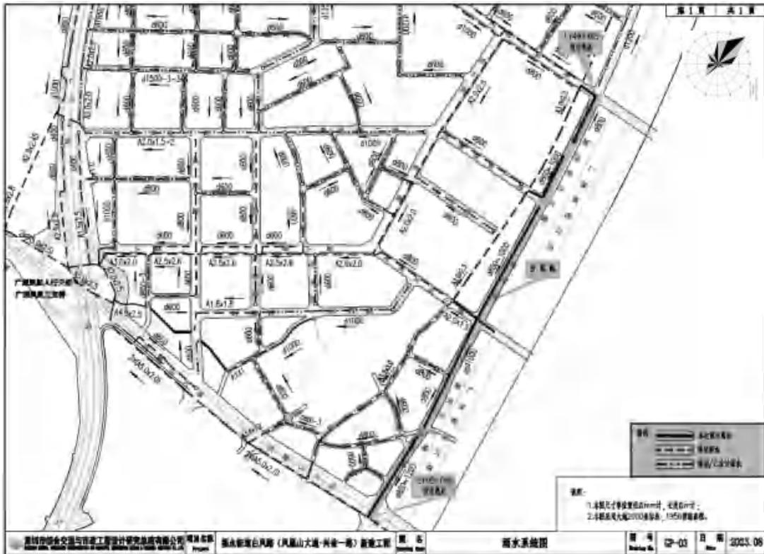
图 2-10 雨水系统图
