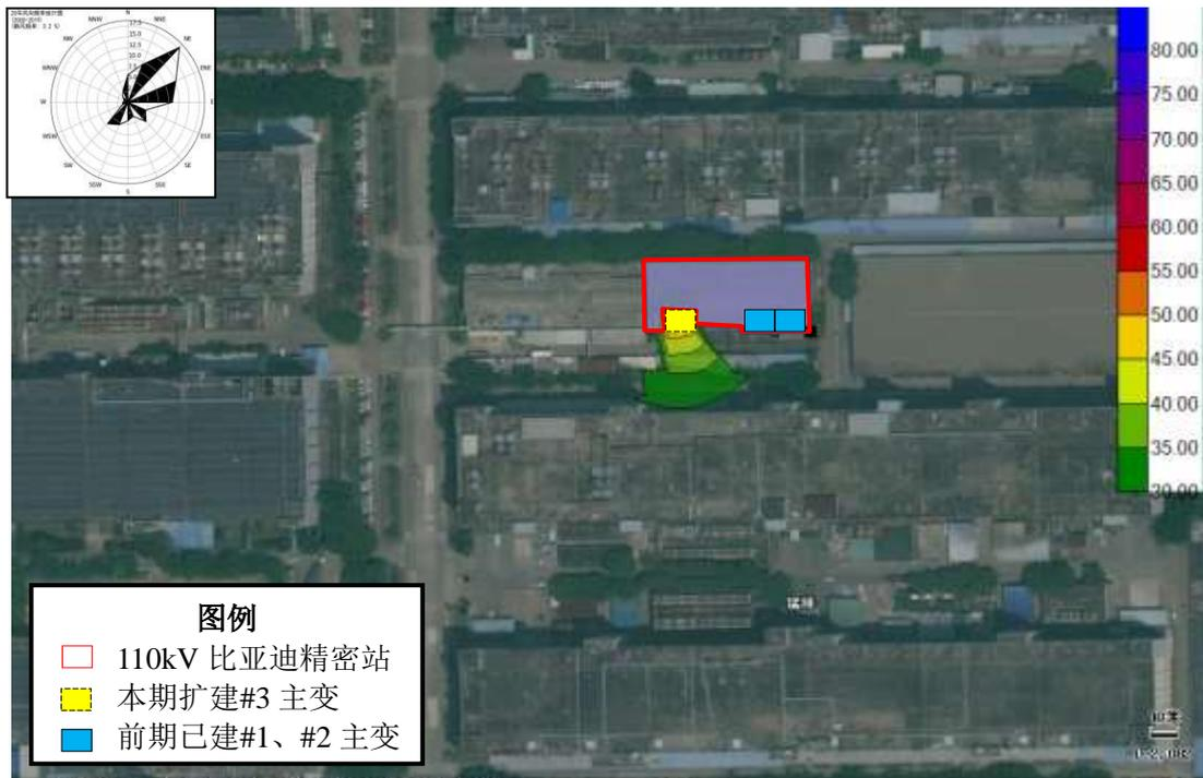
**图 4-1 项目变电站等声线图**
