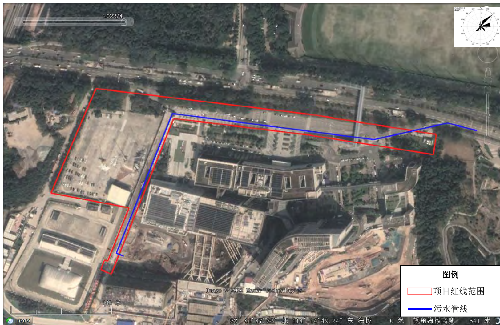
图 3.4-1 项目调查区域污水管网图
