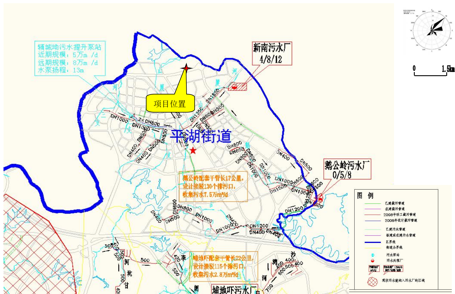
附图 9 项目所在区域污水管网走向图
