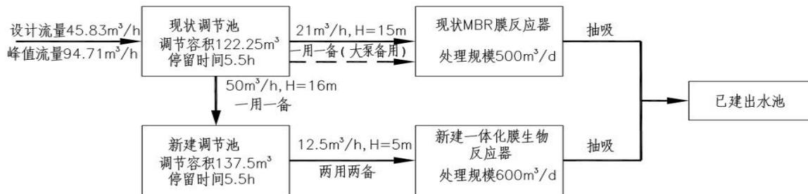
图 2-2 1#临时污水处理站技术路线
