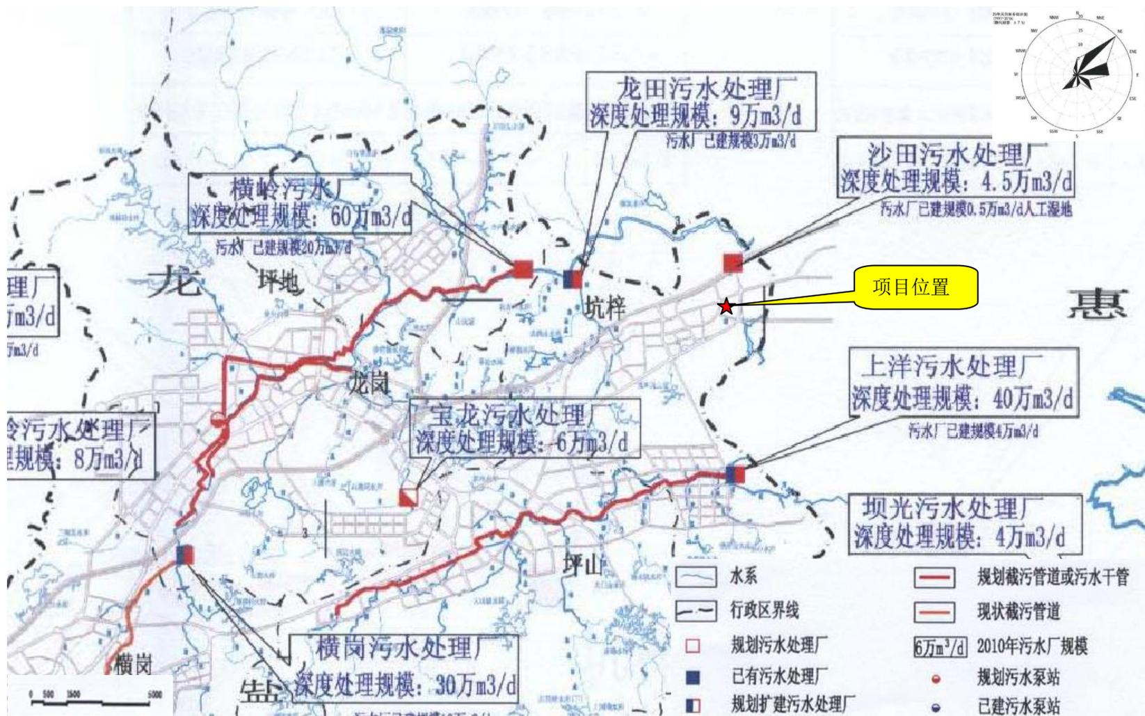
附图 8 项目所在区域污水管网示意图
