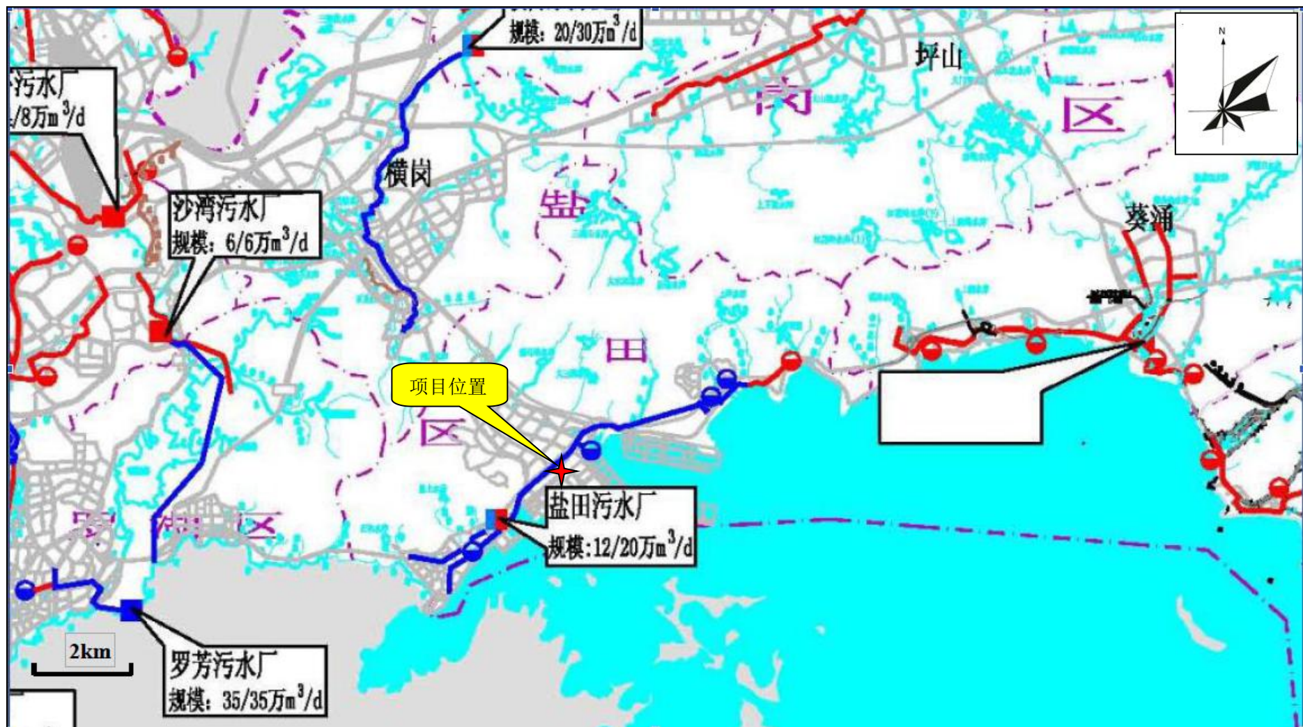
附图 9 项目所在区域污水管网走向图
