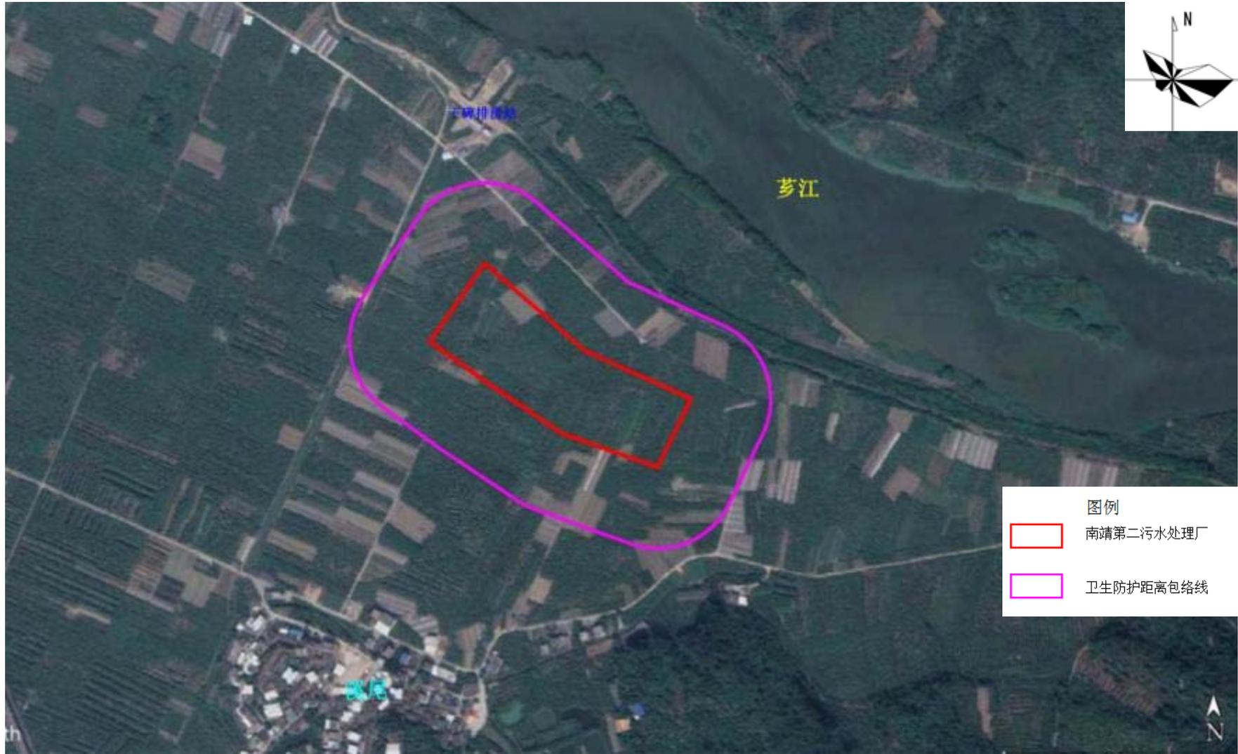
图 5.2-25 南靖第二污水处理厂卫生防护距离包络线示意图
